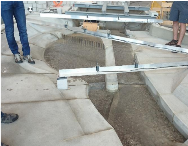
Physisches Modell des Entlastungsbauwerk an der VAW
